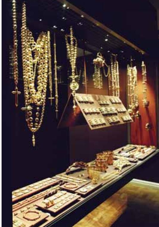
Na vitrine das Jóias de Crioulas, a estrutura de suporte serviu para passagem da iluminação. Na foto menor, o ouro e os detalhes da ourivesaria podem ser observados pela iluminação de 36 terminais de fibra ótica, com fechos direcionados sobre as peças.
